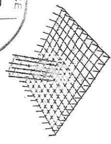
DETALHE ESQUEMÁTICO DAS ARMADURAS DAS SAPATAS EM 3D
