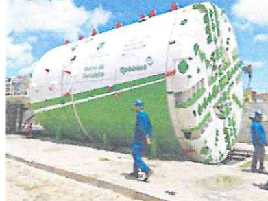
Equipamentos estão passando por montagem prévia no canteiro de obras do Centro. O objetivo é validar o funcionamento de cada componente
